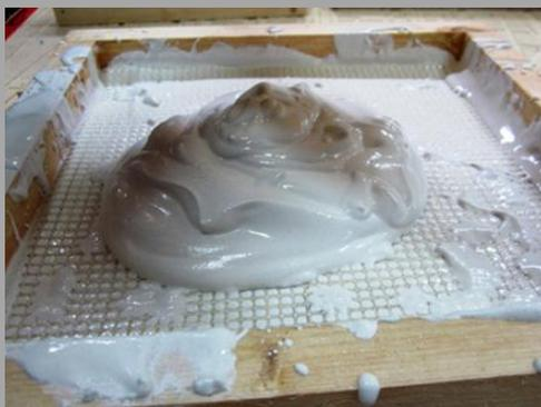
Placer une armature de plastique dans le moule
